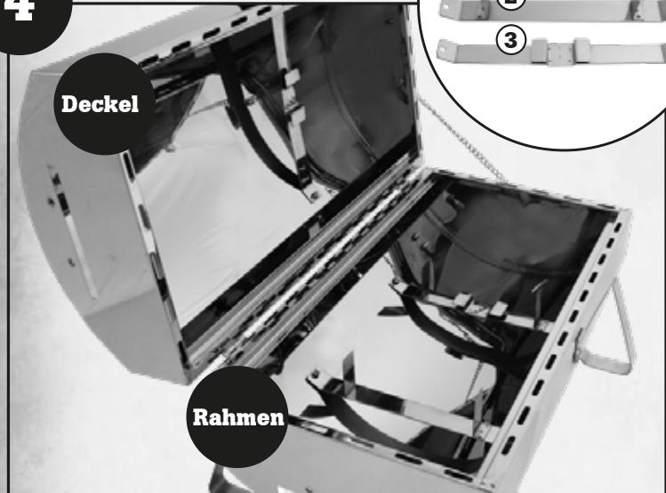
Befestigen Sie die Träger des Heizstabs mit Schrauben und Gegenmuttern in den Rahmen und Deckel des Geräts. In den Rahmen werden Halter befestigt, die die Träger des Spanblechs enthalten (1 und 2). In den Rahmen wird ein Träger befestigt (3).
