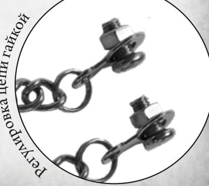
Прикрепите цепь в отверстия на боках устройства между крышкой и корпусом. Отрегулируйте присоединенную к цепи гайку так, что цепь может свободно перемещаться и прикрепите цепь при помощи шайбовой гайки внутри устройства к крышке и корпусу. Затяните болты с помощью гаечного ключа.
