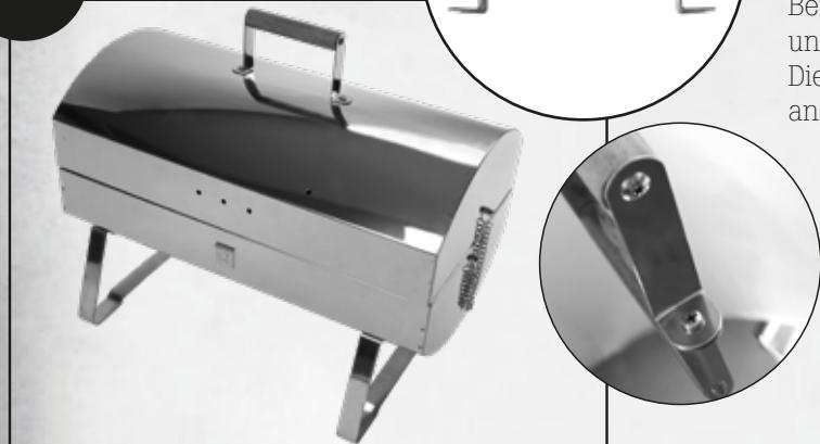
Befestigen Sie den Griff mit zwei Schrauben und Gegenmuttern in den Deckel des Geräts. Die Schrauben mit Schraubenschlüssel anziehen.
