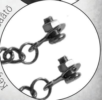
Kiinnitä ketju laitteen sivussa oleviin reikiin kannen ja rungon välille. Säädä ketjussa oleva mutteri niin, että ketju pääsee liikkumaan vapaasti ja kiinnitä ketju laitteen sisäpuolelta laippamutterilla kanteen sekä runkoon. Kiristä ruuvit jakoavaimella.
