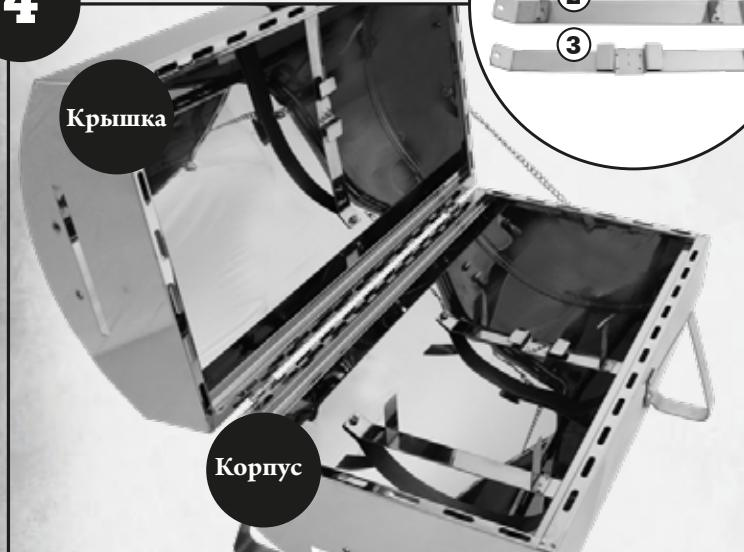
Прикрепите опоры нагревателя болтами и контргайками к корпусу и крышке устройства. К корпусу прикрепляются держатели с опорами пластины для опилок (1 и 2). К крышке прикрепляется одна опора (3).
