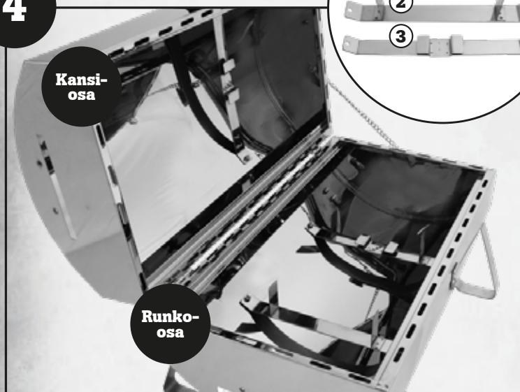
Kiinnitä vastuksen kannattimet ruuveilla ja vastamuttereilla laitteen runko-osaan sekä kanteen. Runko-osaan kiinnitetään kannakkeet, joissa on mukana purupellin kannattimet (1 ja 2). Kansi-osaan kiinnityy yksi kannatin (3).
